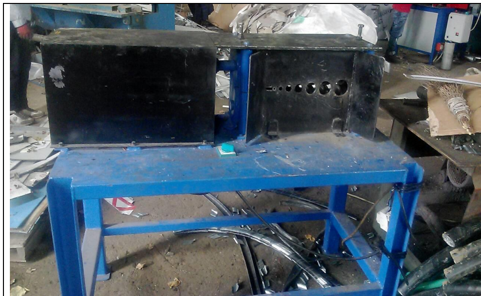
სურათი 4.2. ტექნოლოგიურ პროცესებში გამოყენებული ელექტროკაბელის გასაფუძვნელი დანადგარი (თვითნაკეთი)
