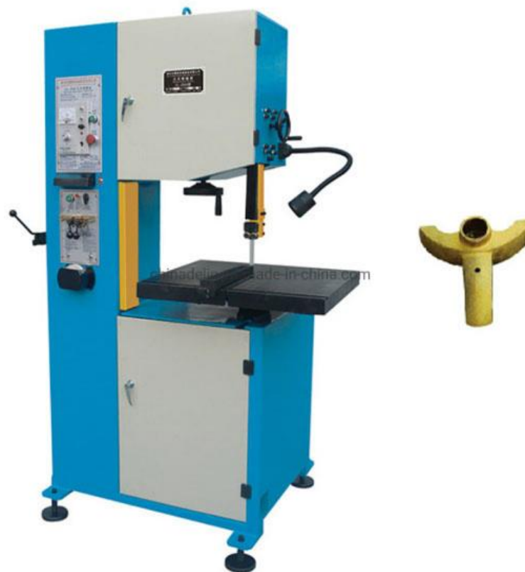
სურათი 4.4. „DL-Z500” მოდელის ვერტიკალური ლენტური ხერხის ტიპური ხედი
