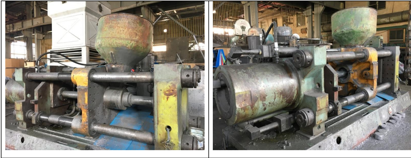
სურათი 4.7. დაქუცმაცებული ალუმინის დასაწნეხი დანადგარი (თვითნაკეთობა)
